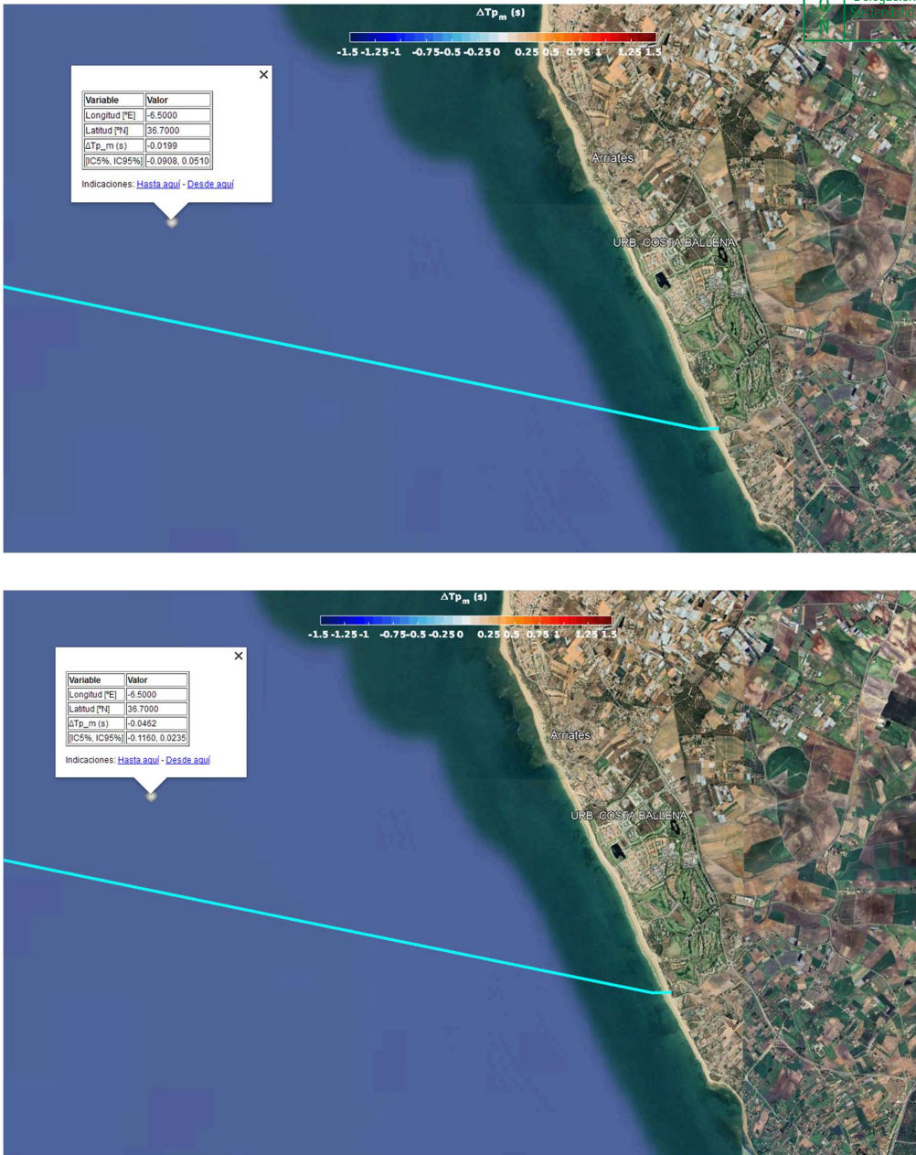
Fig. 7 y 8 Previsiones de variación del periodo de pico de las olas, T_p (RCP 4.5 y RCP 8.5) en Las Canteras (Las Palmas de Gran Canaria)
